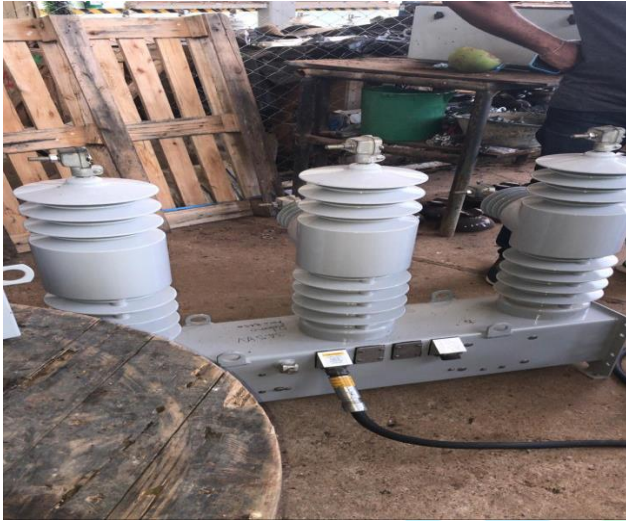
Foto 5. Control de reconectores
